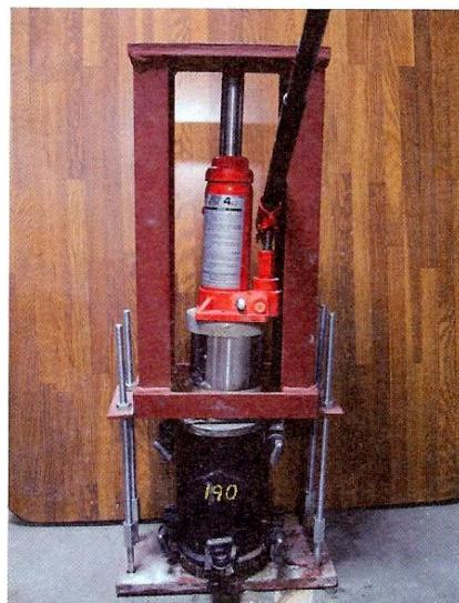
特注の架台と油圧ジャッキを用いて供試体を加圧成型した
